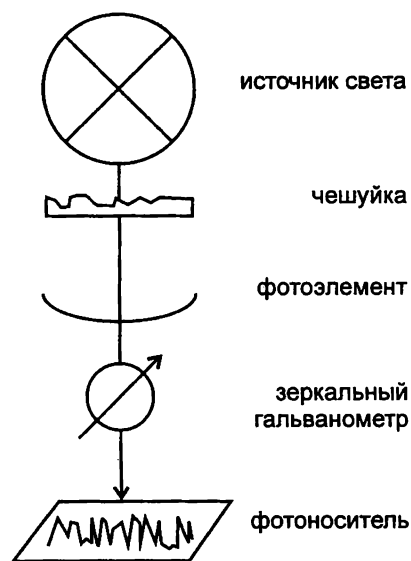
Рис. 11. Схема работы регистрирующего микрофотометра МФ-4
